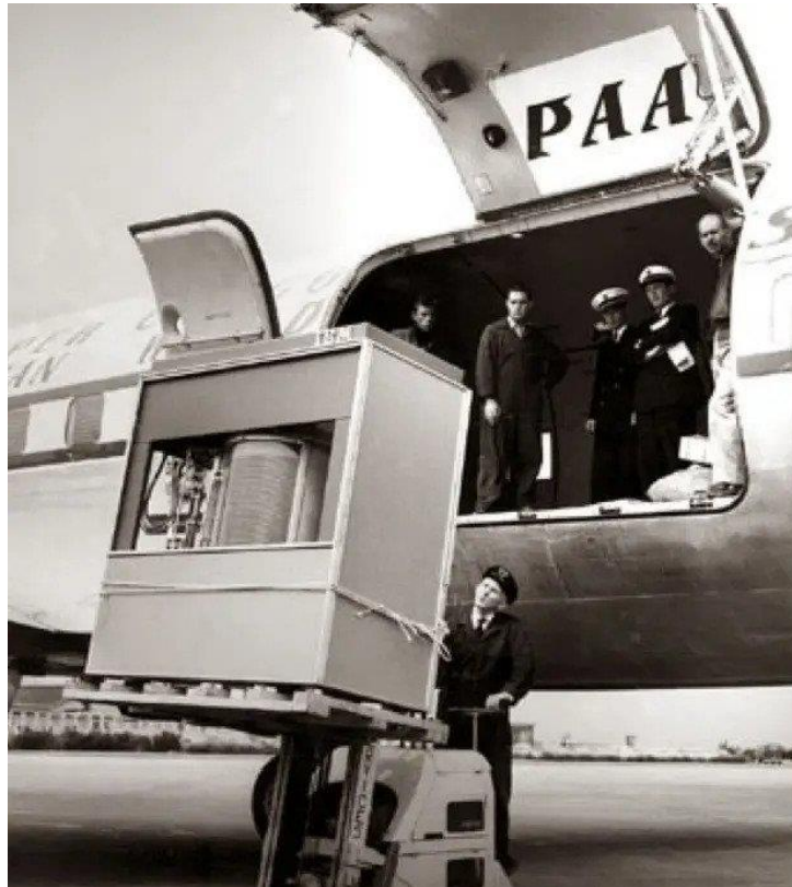
5 pav. 5 MB talpos IBM standusis diskas ruošiamas pervežti lėktuvu (1956 m.)
